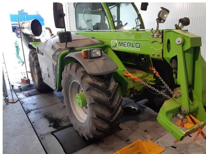
**MotorTest è un sistema dinamometrico composto di meccanica, strumentazione, sistema di controllo e software che consente la rilevazione delle caratteristiche dinamiche di MOTORI ENDOTERMICI di tutti i tipi con la possibilità di rigenerare l'energia di frenatura**
