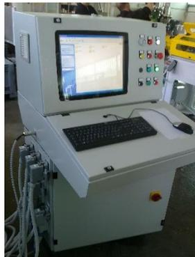
l'**elettronica di condizionamento** dei segnali dai trasduttori elettronici, l'**elettronica di logica** (PLC) e di **acquisizione dati, visualizzatori digitali** della **velocità** del motore (RPM), della **coppia** (Nm), **temperatura** (°C), **personal computer** con monitor colori, tastiera e mouse.
